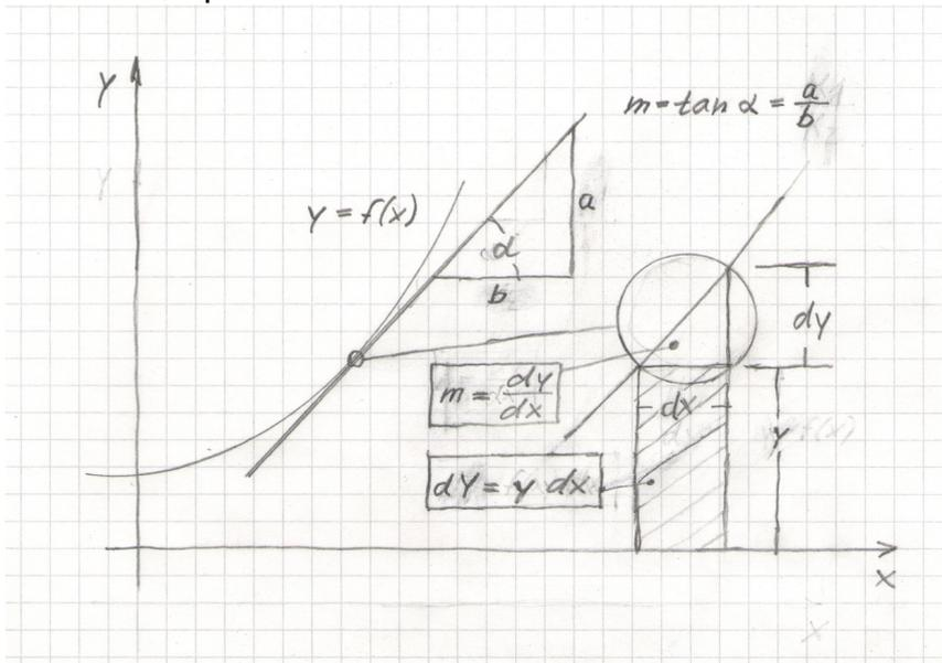
Das Bild oben zeigt, dass der Differentialquotient  $\frac{dy}{dx}$  der Steigung  $m$  entspricht, also ist  $m = \frac{dy}{dx}$
